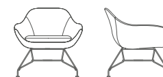
Poltrona, struttura in acciaio Armchair, metal steel tube frame L 80/50 P 80/57 H 46/79
